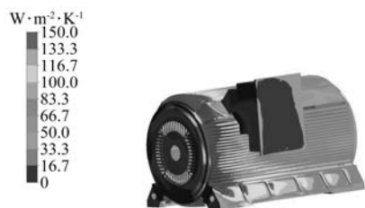
图7 机壳散热系数分布
