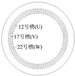
图6 定子绕组周向测温点埋置位置
