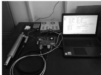
图11 PMSLM控制系统试验装置
