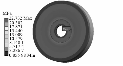
图9 钢制 1 mm 端盖等效应力图
