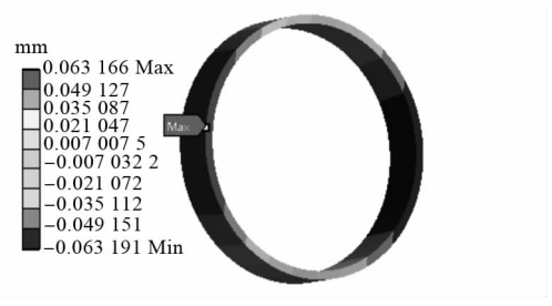
图8 铝制 2 mm 端盖下转子形变图
