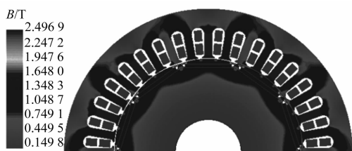
图5 优化后空载磁密云图
