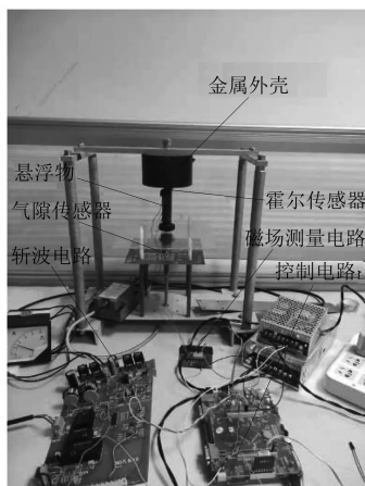
图 13 悬浮试验平台
