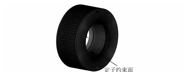
图9 定子结构有限元模型
