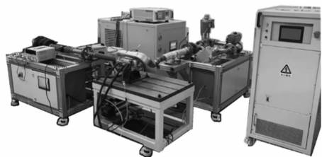
图 10 空压机超速试验布置图
