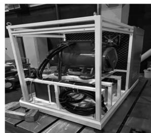
图 5 磁悬浮轴承热泵压缩机柜体安装图
