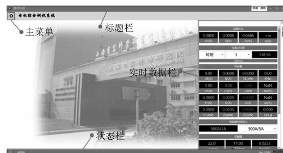
图 3 电机综合测试系统采集分析软件主界面
