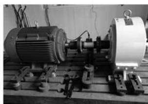
(a) 电机效率试验台
