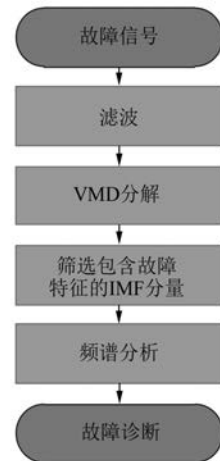
图3 故障诊断流程图
