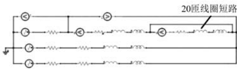
图5 定子匝间短路外电路图
