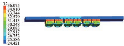
图 19 水冷后空载电动机温度分布
