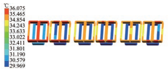
图 21 水冷后空载绕组温度分布
