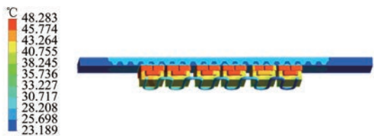
图 22 水冷后负载电动机温度分布
