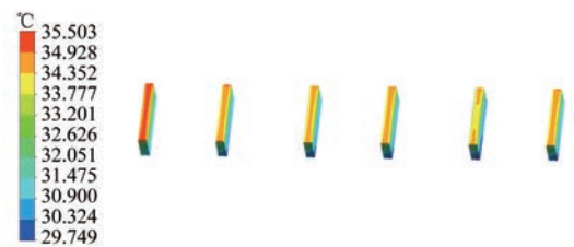
图 20 水冷后空载永磁体温度分布
