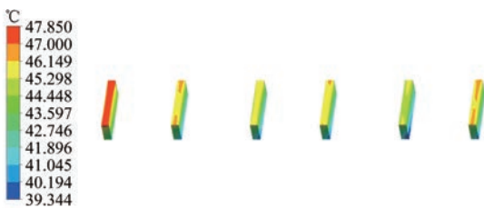
图 23 水冷后负载永磁体温度分布
