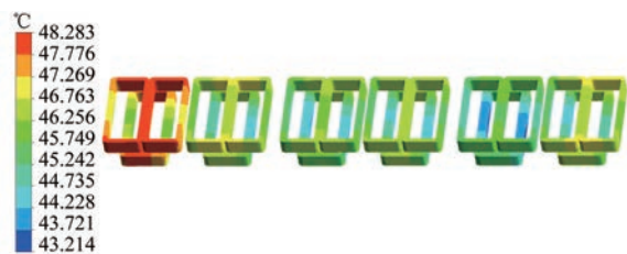
图 24 水冷后负载绕组温度分布
