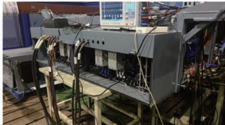
图 11 试验所用的永磁牵引变流器
