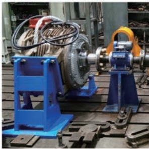
图5 电机温升试验系统
