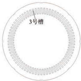
图4 定子铁心测温点周向埋置位置
