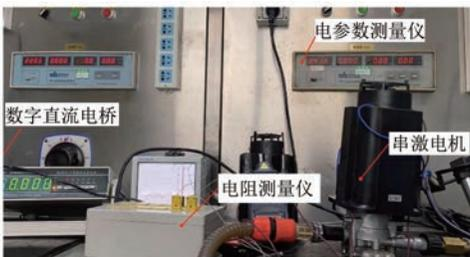
图5 串激电机温升测试
