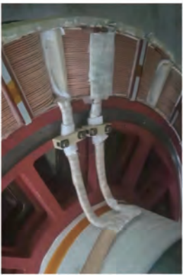
图 4 正负端两路并联焊接完成并引出图
