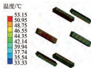
图 7 双凸极永磁电机永磁体温度分布图
