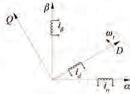
图 11 永磁同步电机等效四线圈物理模型
