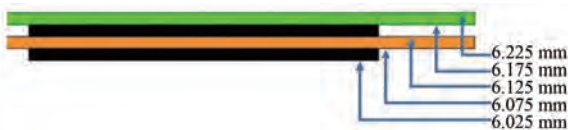
图 14 第六圈柔性 PCB 绕组半径尺寸平面展开图
