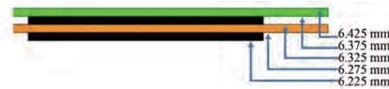
图 12 第四圈柔性 PCB 绕组半径尺寸平面展开图
