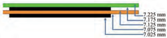
图 9 第一圈柔性 PCB 绕组半径尺寸平面展开图
