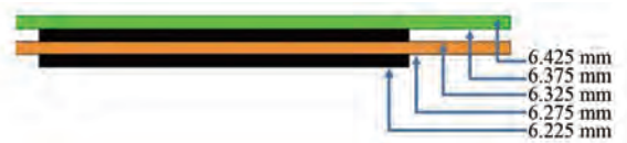
图 13 第五圈柔性 PCB 绕组半径尺寸平面展开图
