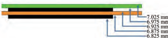
图 10 第二圈柔性 PCB 绕组半径尺寸平面展开图
