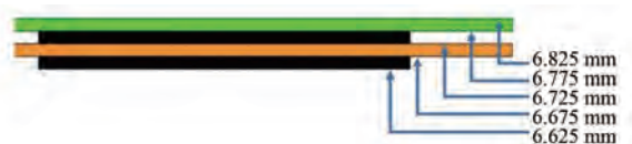
图 11 第三圈柔性 PCB 绕组半径尺寸平面展开图
