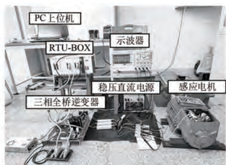
图11 基于 Rtunit 快速原型开发系统的可编程电流源实验平台
