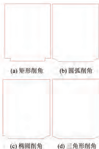
图7 电机转子铁心肩部削角结构示意图
