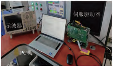
(a) 示波器、PC机和伺服驱动器
