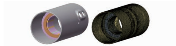
图 9 壳体-定子等效结构模型以及网格剖分图
