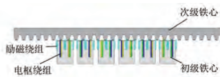
图 1 电励磁通切换直线磁悬浮电动机结构 Fig. 1 Structure of EEFSLMSM
