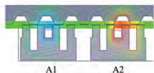
图 2 磁通正向最大位置 Fig. 2 Forward maximum position of magnetic flux
