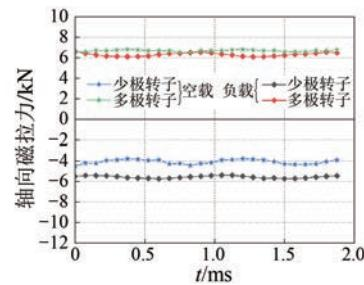
图 11 空载和负载条件下的轴向力分析
