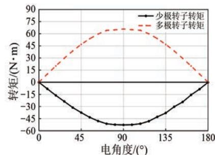
图 5 固定多极转子的矩角特性
