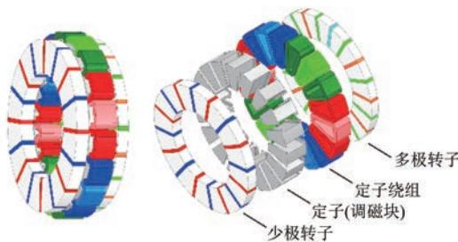
图 1 聚磁式轴向磁齿轮复合电机三维模型
