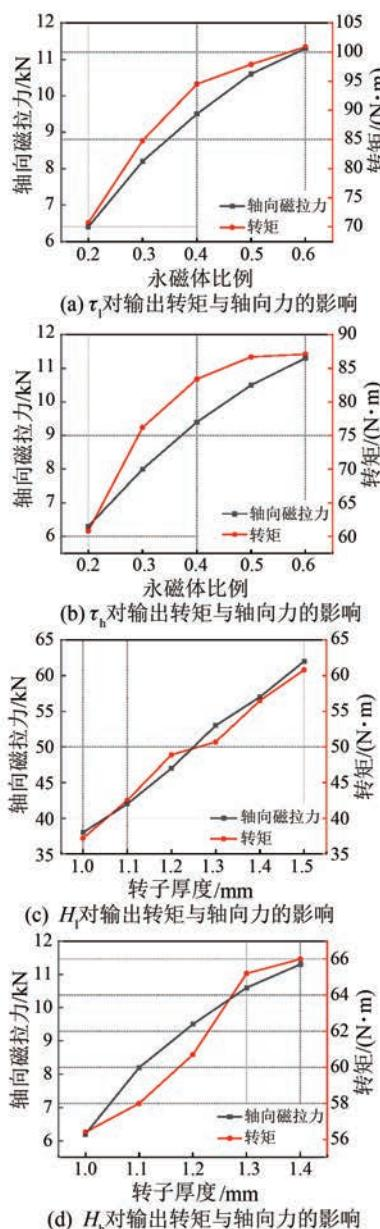
图 10 永磁转子各参数对输出转矩与轴向磁拉力的影响
