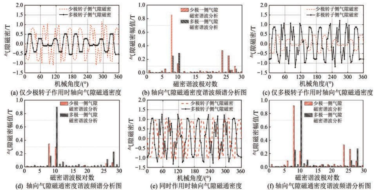
图 4 不同情况下的气隙磁密分析结果
