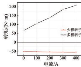
图 8 电流大小与多极输出转矩的关系
