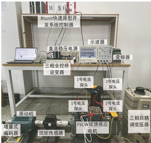
图 11 FSCW 双馈感应电机试验样机平台
