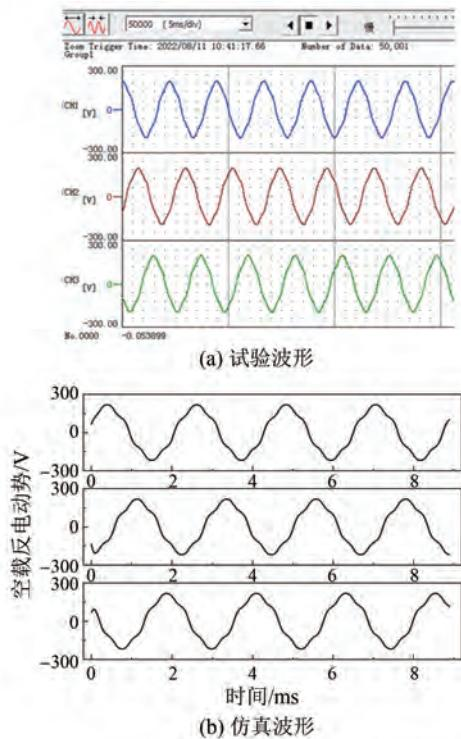
图 12 样机空载反电动势波形
