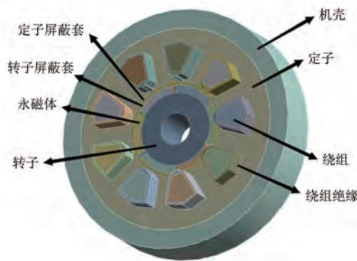
图 3 电机温度场有限元计算模型
