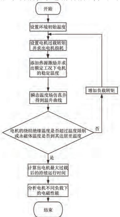
图 1 电机性能仿真流程图
