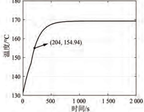
图 7 2 倍负载时绕组绝缘温升曲线
