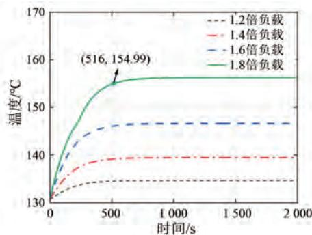
图 5 不同负载下绕组绝缘温升曲线
