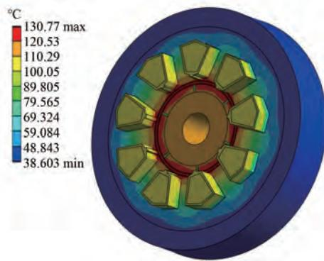
图 4 电机额定工况下稳态温度场温度分布图
