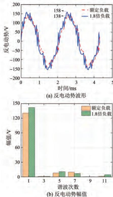
图 10 电机负载反电动势波形图
