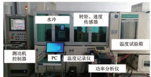
图 16 样机测试平台
